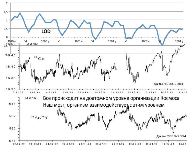
Рис. 13. Вверху: скорость счета бета-источника  $^{60}\text{Co}$  со счетчиком Гейгера СБМ-12. Усреднение 5 суток. Внесена поправка на снижение активности источника с периодом полураспада 5,26 лет. Внизу: скорость счета бета-источника  $^{90}\text{Sr}-^{90}\text{Y}$  со счетчиком Гейгера СБМ-12. Усреднение 30 часов. Внесена поправка на снижение активности источника с периодом полураспада 28,6 лет.
