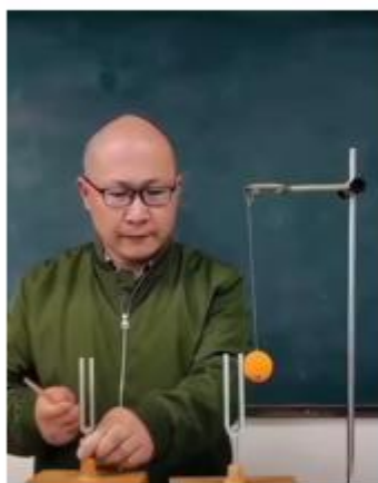
Камертоны из разного материала и разное расстояние между пластинами – энергия не передается на шар
