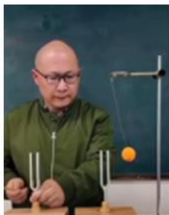
Одинаковый материал камертонов и одинаковое расстояние между пластинами – энергия передается на шар
