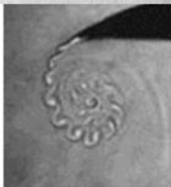
Фотография жидкости около квадратной пластинки, движущейся с ускорением от состояния покоя до скорости 24 фут/сек
